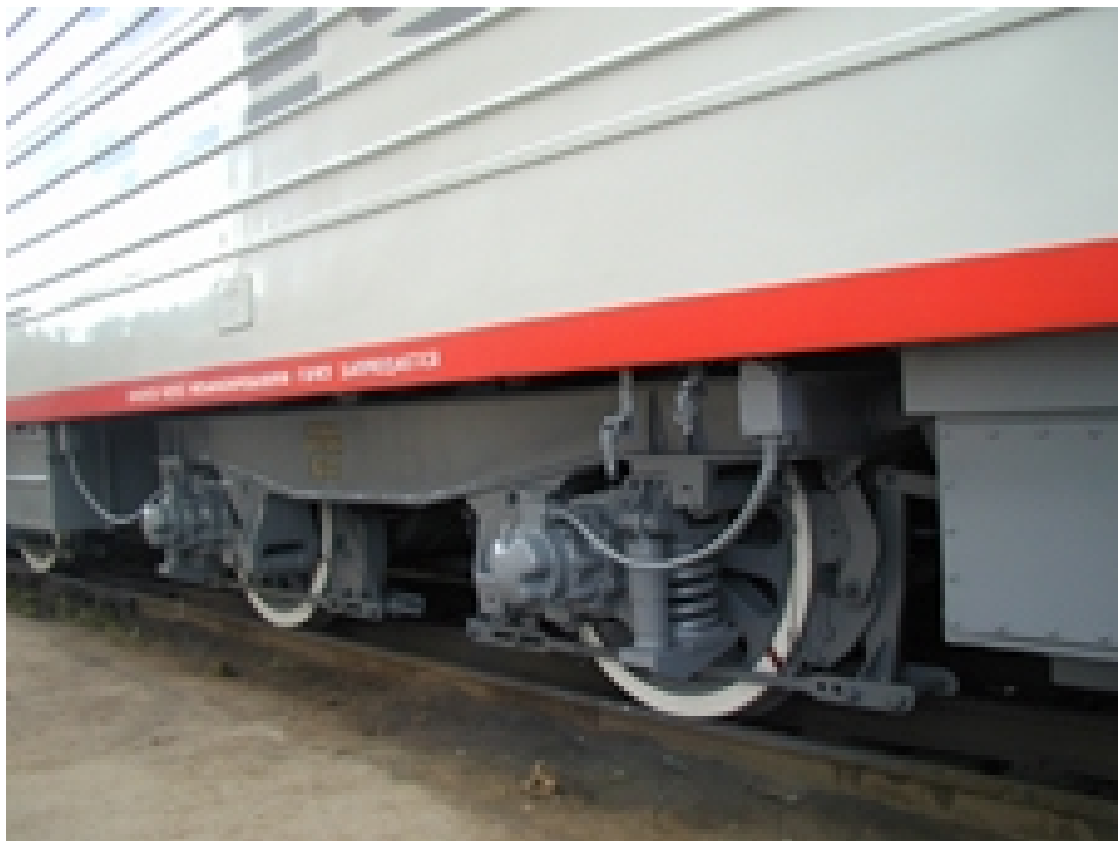
Рис. 3.25. Механическая часть электровоза ЭП10
