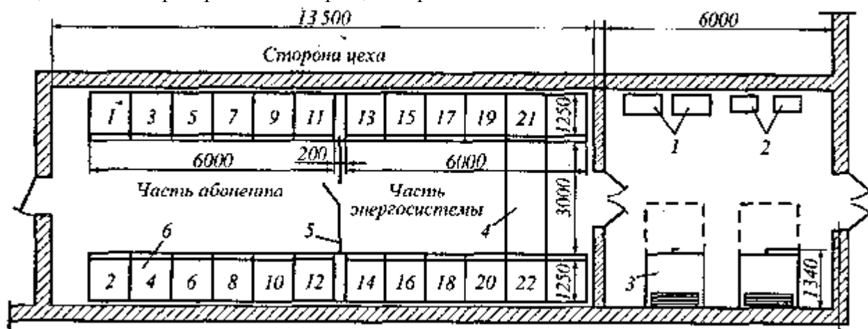
Рис. 7.8. Расположение оборудования распределительной подстанции напряжением 10 кВ при двухрядном расположении камер КСО при разделении распределительной подстанции на части абонента и энергосистемы: 1 - блоки питания; 2 - щитки защиты; 3 - шкаф оперативного тока типа ШУОТ; 4 - мост шинный длиной 3000 мм; 5 - ограждение сетчатое с дверью; 6 - камера типа КСО-272
